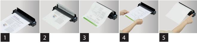
**1** Das Blatt mit der Vorderseite nach oben gewandt einlegen und die Scan-Taste drücken **2** Der iX100 scannt die Vorderseite. **3** Die Seite wird mit der Vorderseite nach unten ausgegeben (bei Einstellung der U-förmigen Papierführung). **4** Das Blatt erneut zuführen, ohne die Scan-Taste zu drücken. **5** Die Rückseite wird gescannt. Die Scan-Taste zur Beendigung des Scanvorgangs und Erzeugung einer PDF-Bilddatei drücken.
